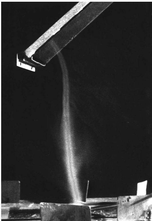
Рис. 4.4. Сжатие газового вихря на входе в воздухозаборник реактивного двигателя самолета (на стоянке)
